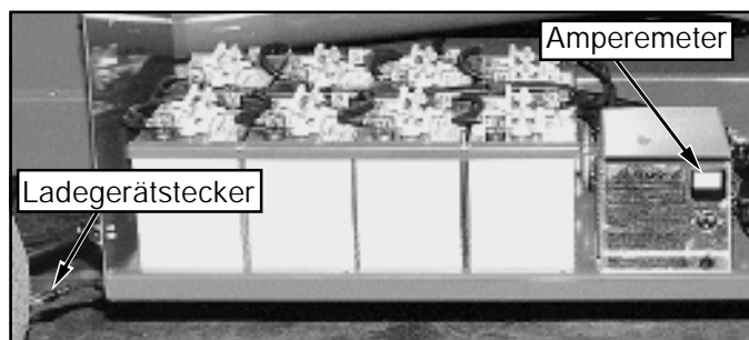
Bild 6: Leistungsmodul, rechte Seite des Fahrwerks
